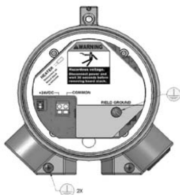
盖子拆除后的光源接线端
